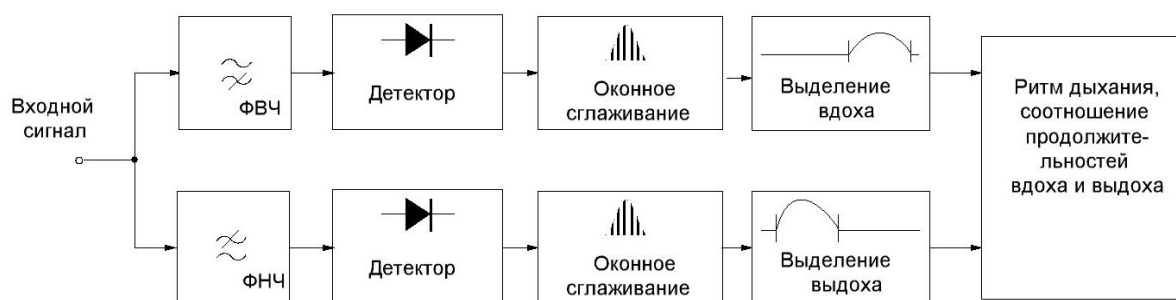
Рис. 1. Функциональная схема выделения фаз дыхания и ритма дыхания водолаза с дыхательным аппаратом открытого цикла
