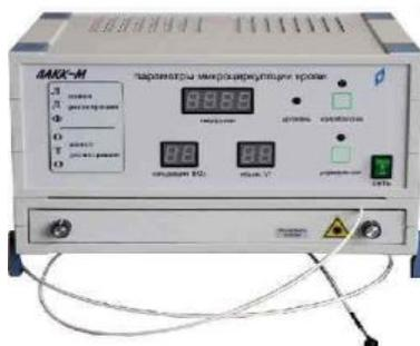
Рис. 1. Лазерный анализатор «ЛАКК-М»
